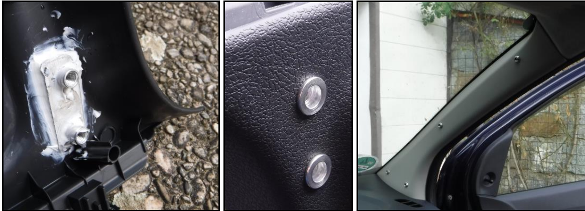
Links und Mitte: Die Befestigungen für die Garnischen bestehen aus Nietmuttern Rechts: Druckknöpfe dienen dann zur Vorhangbefestigung an der Seite (auch im hinteren Fahrgastbereich)
