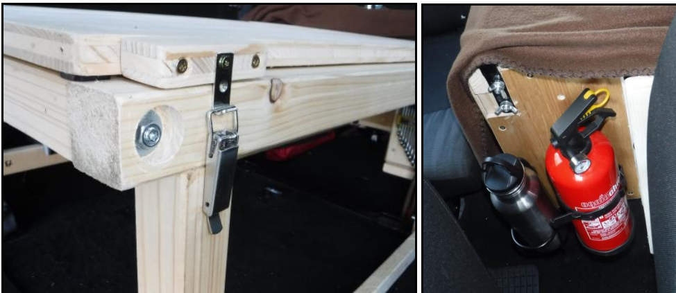
Links: Verschluss für Bett-Platte Rechts: Feuerlöscher und Trinkflasche von vorne erreichbar
