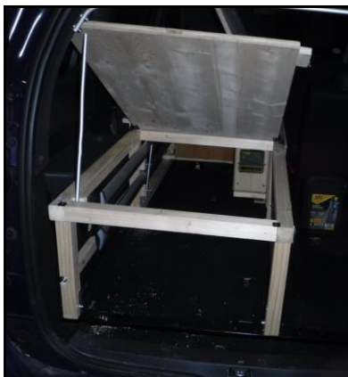
Links und Mitte: Streben für die Klappen getestet Rechts: Aufprallschutz (wenn Bett von hinten nach vorne geschoben werden würde, sollen hier die dünnen Sparx abreißen und der hintere Teil nach rechts versetzt nach vorne rutschen, der vordere Teil sollte an Ort und Stelle bleiben und nicht in den Fahrersitz gedrückt werden)
