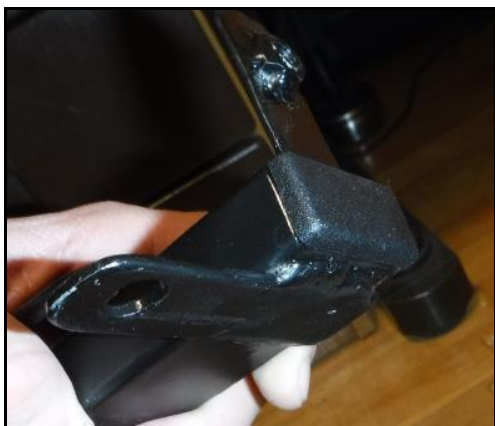
Links: Kunststoffkappen am Ende der Formrohre Rechts: Bett ist fixiert
