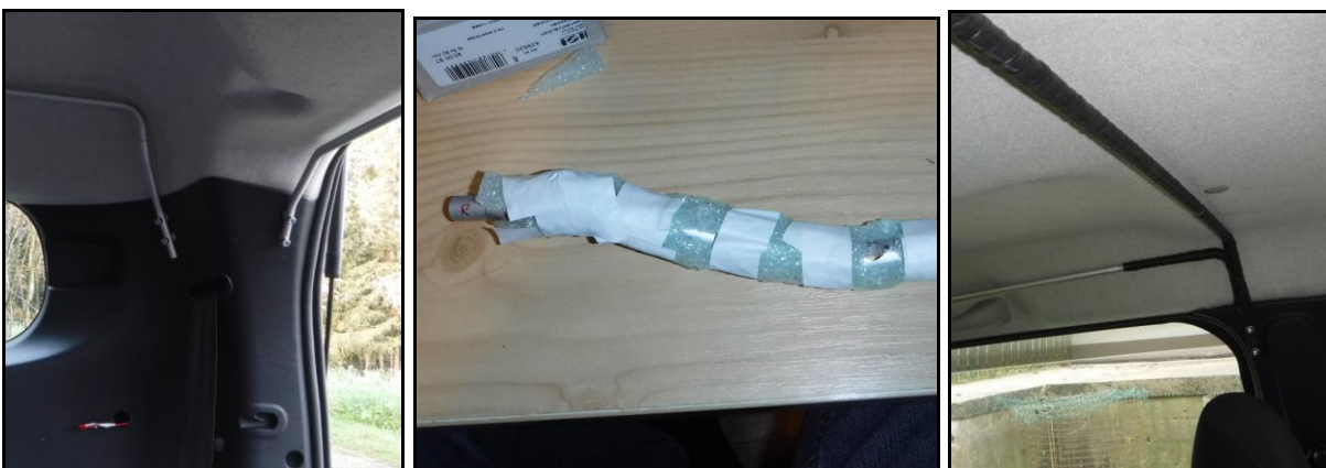
Links: erste Montageversuche nach dem Biegen Mitte+ Rechts: An Stellen, wo es gefährlich ist wegen Kopf-anstoßen, wurden die 10x1er Alurohre mit Schaumstoffband und Isolierband umwickelt, darüber dann mit selbstverschweißendem Isolierband (gummiartig)
