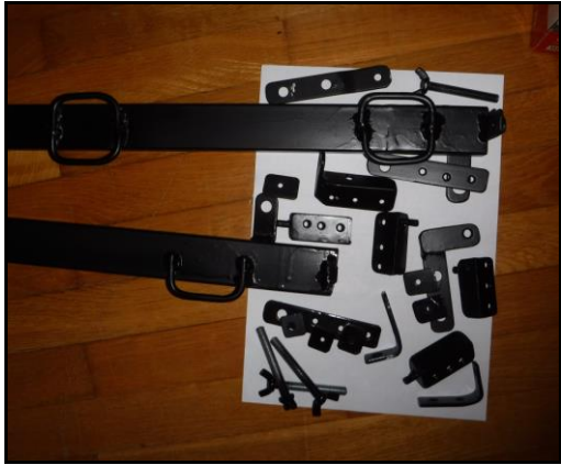
Links: Beschläge lackiert (die Flügelschrauben werden später durch Inbusschrauben ersetzt) Rechts: Beschläge montiert
