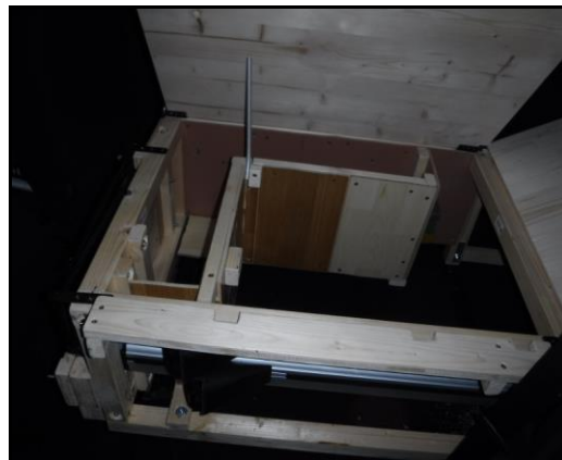
Links und Mitte: Streben für die Klappen getestet Rechts: Aufprallschutz (wenn Bett von hinten nach vorne geschoben werden würde, sollen hier die dünnen Sparx abreißen und der hintere Teil nach rechts versetzt nach vorne rutschen, der vordere Teil sollte an Ort und Stelle bleiben und nicht in den Fahrersitz gedrückt werden)
