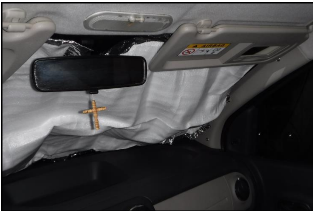
Links: Sonnen- & Kälteschutz, der zwischen Scheibe und Vorhang gegeben werden kann Rechts: zusätzlicher Vorhang hinter den Vordersitzen
